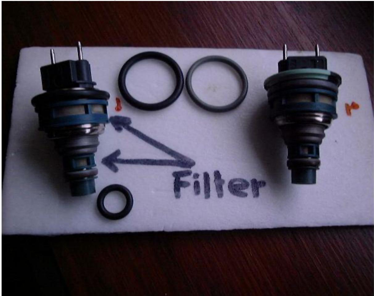
Am Bild gut zu sehen, die org. Bosch-Dichtungs-Ringe (rechts), Farbe grau, 2.75x 20 mm groß und ziemlich teuer .Einzelpreis 9 Euro + MwSt.
