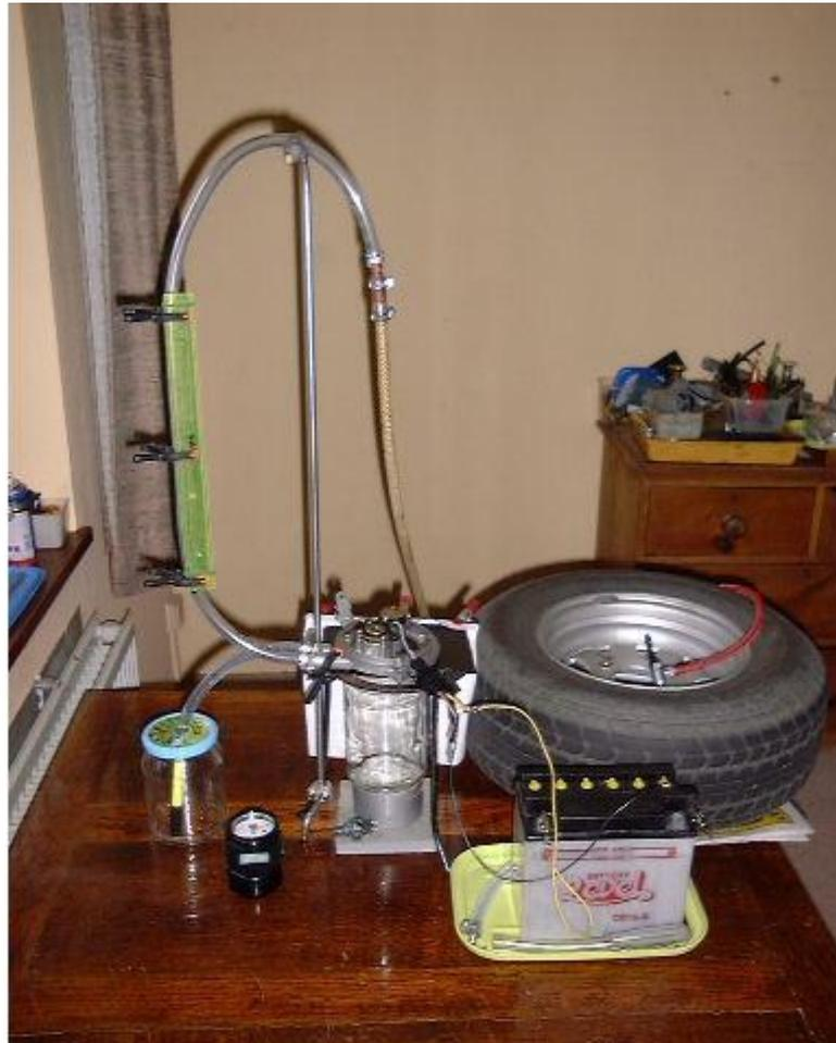
Systemdruck aus dem Reifen . So kann man den Druck exakt vorgeben und natürlich leicht und schnell ändern.
