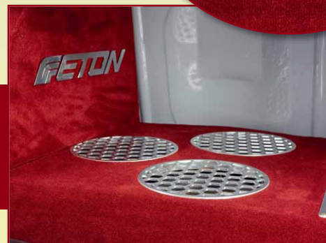
Das aus 3-Millimeter Alu gefertigte Eton-Logo ist eins von vielen selbst gefrästen Details
